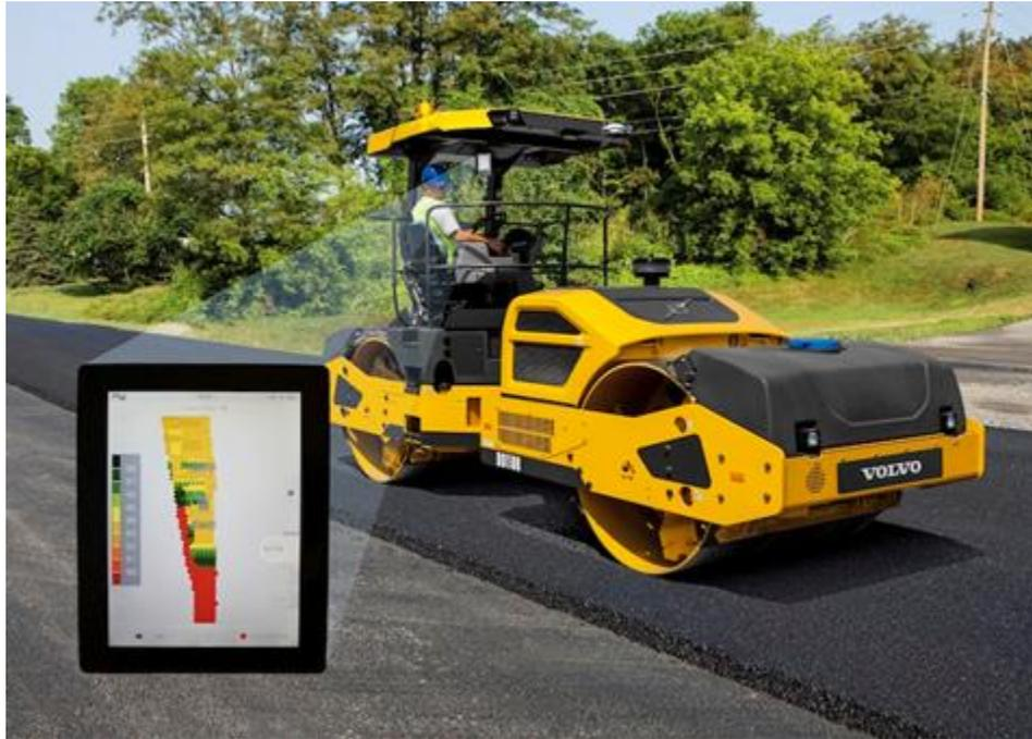
Figure 3.9: Exemple d'équipement de compaction avec affichage d'indice de compaction (source: [www.constructionequipment.com](http://www.constructionequipment.com))
