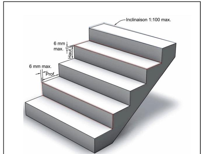
Quant à la partie 9, l'article 9.8.4.4 précise que les tolérances dimensionnelles sont d'un maximum de 6 mm de variation tolérée dans la profondeur des marches ou la hauteur des contremarches et une inclinaison maximale de 1 : 100.
