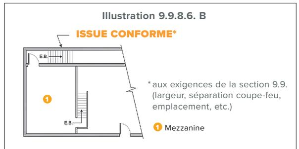
La distance de parcours pour atteindre l'issue la plus proche se mesure de la même manière que pour une aire de plancher. Ainsi, la distance de parcours maximale d'un point quelconque de la mezzanine jusqu'à l'issue la plus proche ne doit pas dépasser :
