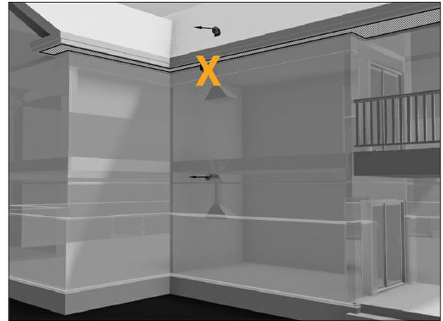
Ne jamais placer les sorties d'air chaud et humide près des soffites, où l'air aspiré cause de la condensation dans les combles.
